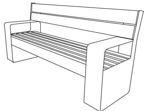
**ВАЖНО!** Перемещение готового изделия осуществлять за металлические части, чтобы не допустить отрыв отдельных брусков.
